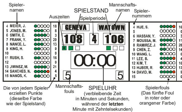
Abbildung 6: Anzeigetafel Klassifizierungsstufe 1
