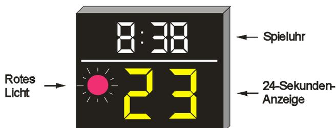
Abbildung 7: 24-Sekunden-Anlage
