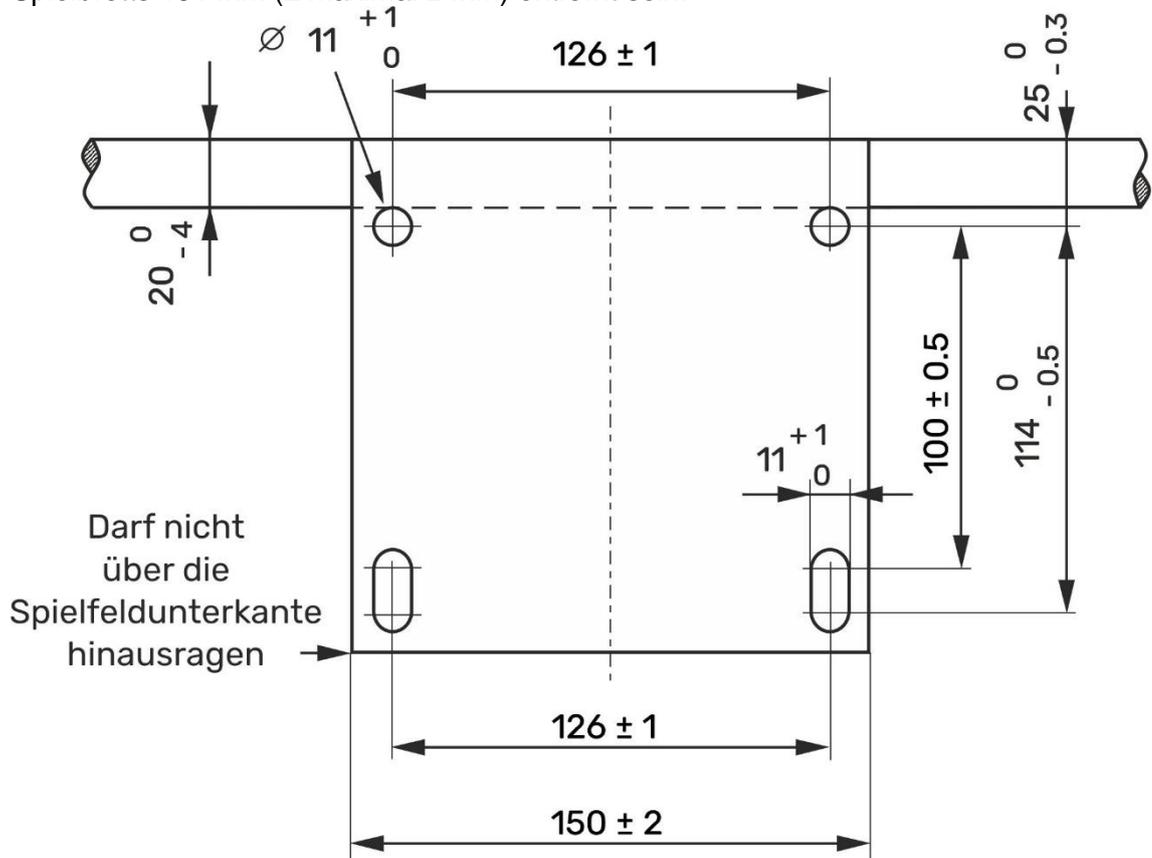
**Bild 6 Montageplatte des Rings (Maßangaben sind Beispiele)**
