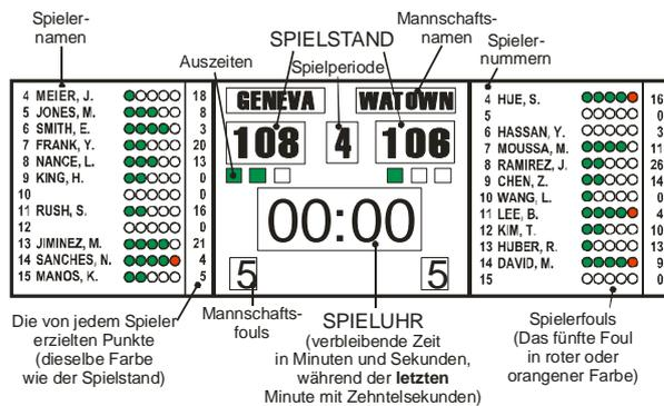
Abbildung 6: Anzeigetafel Klassifizierungsstufe 1
