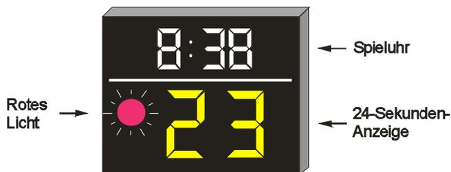
Abbildung 7: 24-Sekunden-Anlage
